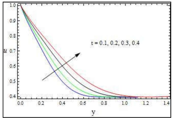
Fig 7. The velocity Profile for  $u$  against  $t$  with  $\alpha = 1$ ;  $M=2$ ;  $D=1$ ;  $t=0.1$ ;  $Sc=2$ ;  $R=1$ ;  $Gr=5$ ;  $Gm=10$
