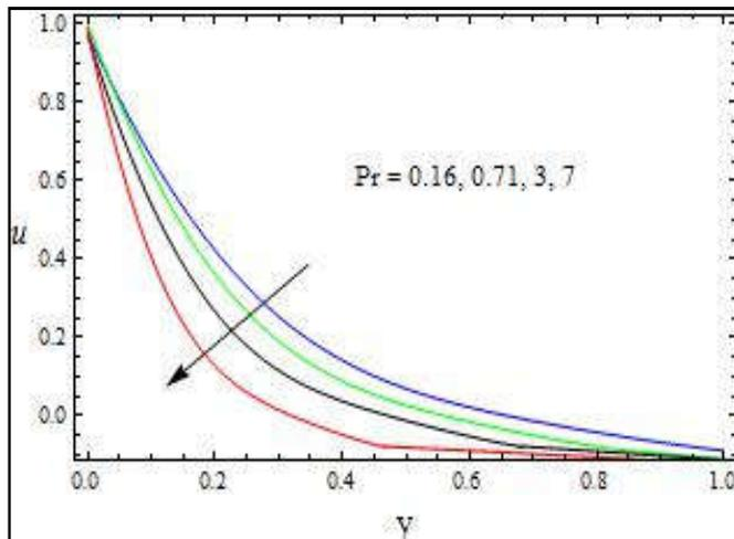
Fig. 6. The velocity Profile for  $u$  against  $Pr$  and  $t$  with  $\alpha = 1$ ;  $M=2$ ;  $D=1$ ;  $t=0.1$ ;  $Sc=2$ ;  $R=1$ ;  $Gr=5$ ;  $Gm=10$
