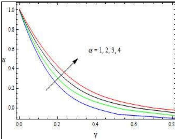
Fig. 5. The velocity Profile for  $u$  against  $\alpha$  with  $D=1$ ;  $P=0.71$ ;  $t=0.1$ ;  $R=1$ ;  $Sc=2$ ;  $M=2$ ;  $Gr=5$ ;  $Gm=10$
