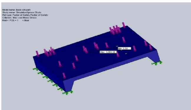
Fig. 4. Max. von mises stress of base
